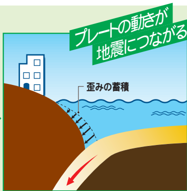
大陸プレートの先端部が引きずり込まれて歪み、地殻が圧縮される
